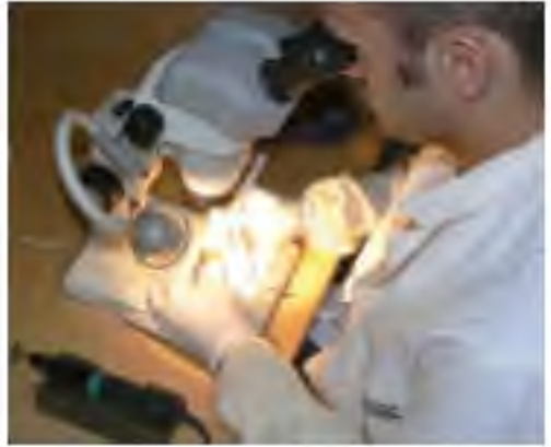
[fig 3] Pulitura in corso di una moneta sotto microscopio stereoscopico attraverso picchettatura con bisturi.
